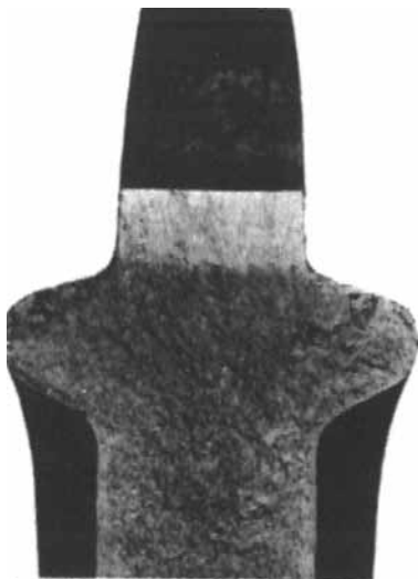
Corte de una rueda dentada Rexnord de acero fundido que muestra la profundidad de las secciones de desgaste endurecidas.
